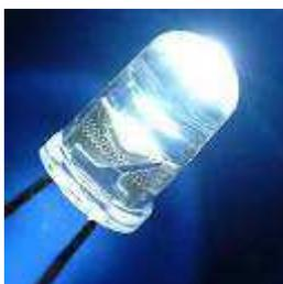
Il **LED** (Light Emitting Diode) è un diodo, componente elettrica avente una sola direzione, motivo per cui non necessita di riflettori e di ottiche particolari, che assorbirebbero gran parte della luminosità emessa. È composto da un chip, ricoperto da una resina che accumula la fluorescenza, da un'ottica e da due terminali elettrici.
